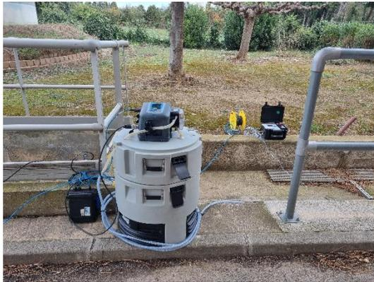
Débitmètre et câble d'asservissement au volume écoulé en sortie
